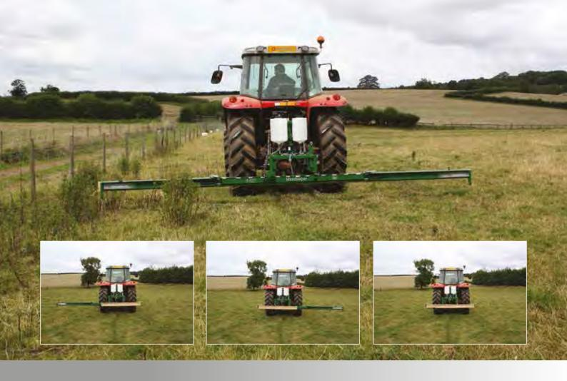
Le Weedwiper est un appareil de désherbage par contact particulièrement adapté aux cultures fragiles. Intégrant une technologie inédite et innovante, il permet de traiter efficacement les mauvaises herbes dépassant de la culture, sans risques de gouttage, garantissant ainsi une protection maximale des plantes à préserver.
