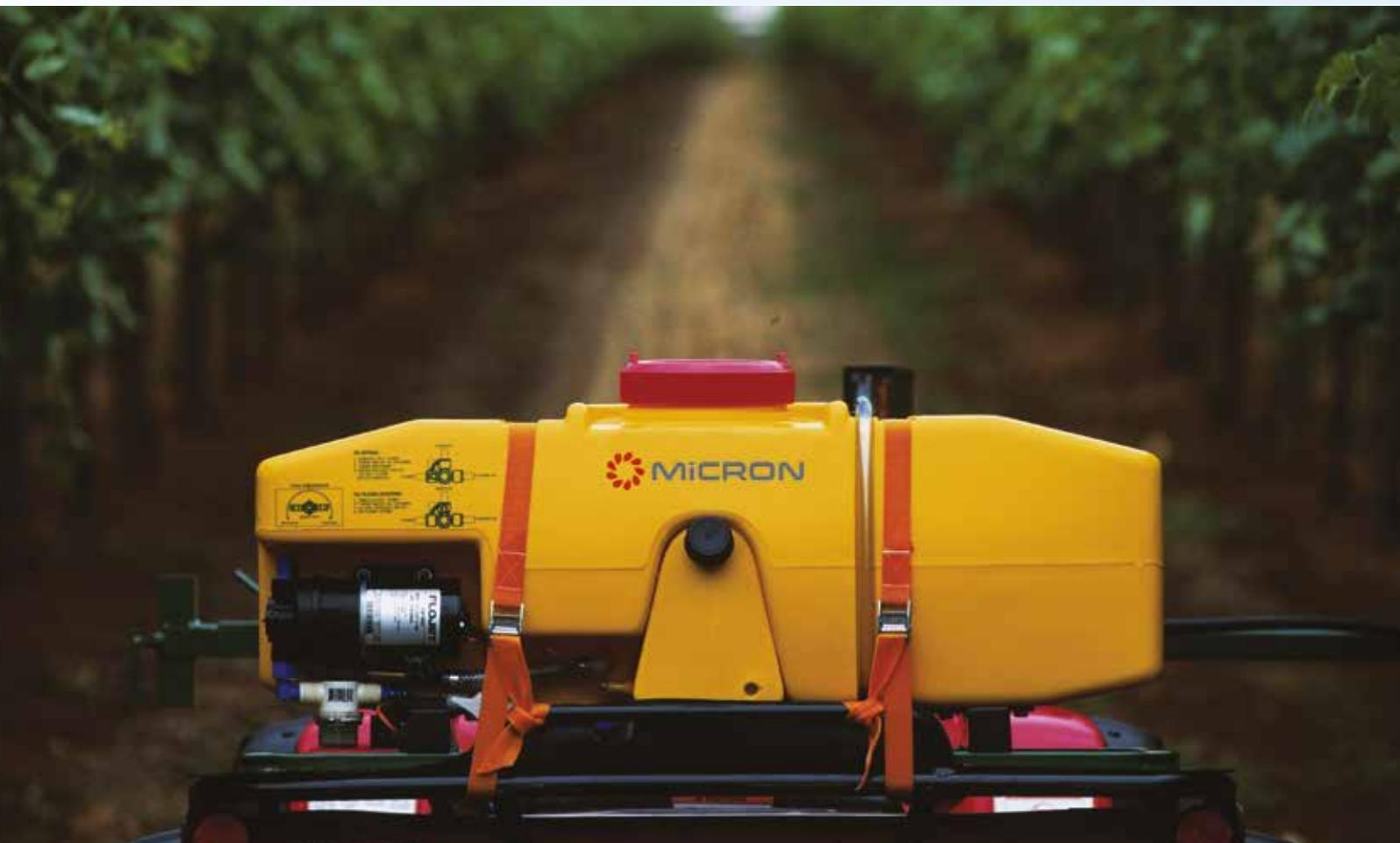
Diseñado específicamente para su uso con equipos de bajo volumen, en especial unidades de CDA (Aplicadores de gota controlada), el sistema de tanque Micron adecuado para vehículos todo terreno y pequeños vehículos utilitarios ofrece una mayor productividad y aplicación eficiente.
