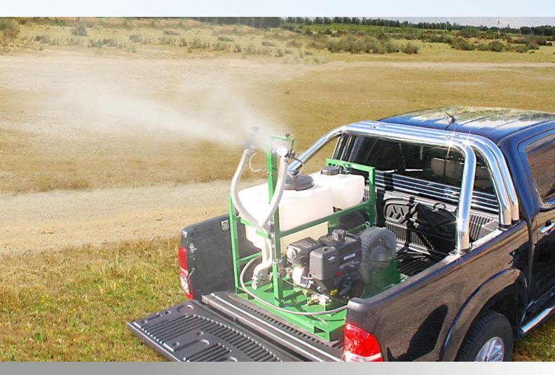
Le Micron AU9000 est un nébuliseur à froid monté sur le véhicule, conçu pour être utilisé avec des formulations ULV à la fois classiques et miscibles à l'eau. Parmi ses utilisations figurent le contrôle des moustiques adultes et des mouches, ou la lutte contre des parasites similaires, ainsi que la désinfection et le contrôle des odeurs.
