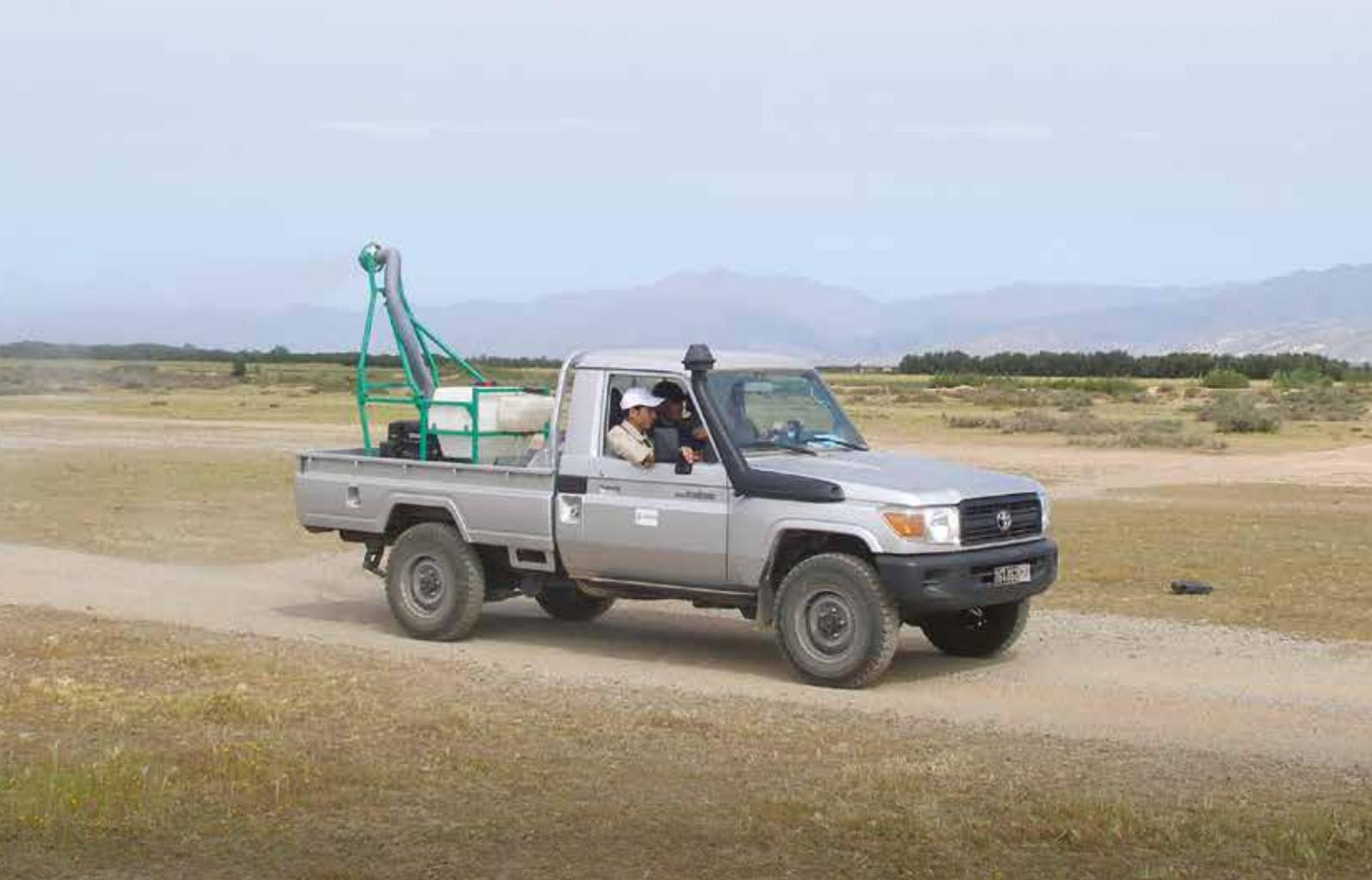
Модель AU8115 компании «Майкрон» является автономным опрыскивателем с регулируемым размером капли аэрозоля (РРКА), который монтируется на транспортное средство и предназначен для выполнения широкого спектра работ в борьбе с мигрирующими вредителями, в сельском хозяйстве и здравоохранении.
